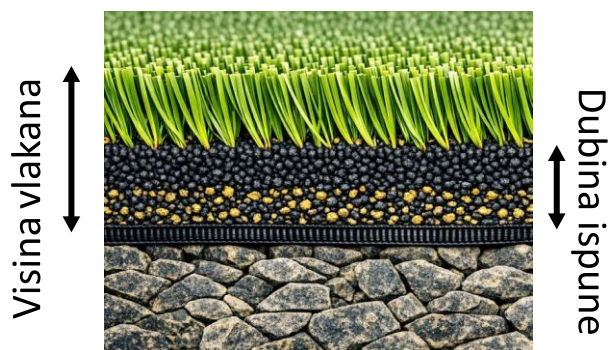
S ispunom: dubina ispunje je najmanje 50% visine vlakana
