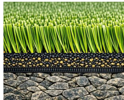
S polu-ispunom: dubina ispunje je između 25% i 50% visine vlakana
